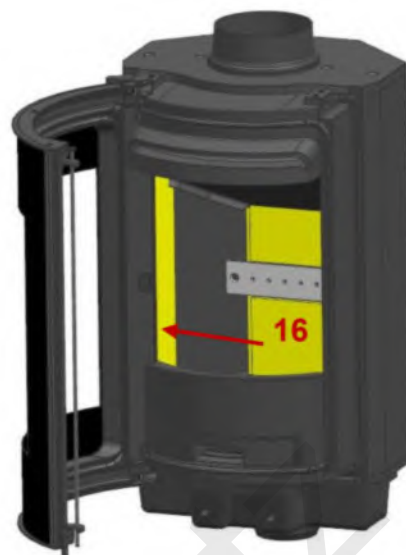
16 : Poser le réfractaire coté gauche sur la sole foyère et contre le coté gauche.
